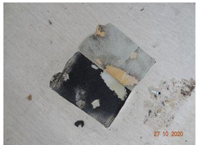
F 015 + 020: Geb. 55 A EG, Bodenbelag Beige + Kleber aus Wohnraum, Probe P5 ( Chrysotilasbest in Schwarzanzhaftung )
