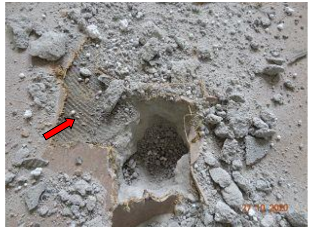
F 069 + 070: Geb. 55 T2 EG, Ausgleichmasse unter Bodenbelag aus R. 0.08, Probe P16 ( asbestfrei )
