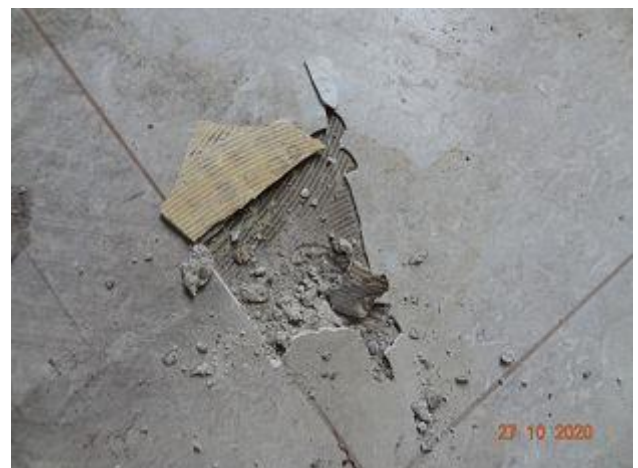
F 063 + 064: Geb. 55 T1 EG, Bodenbelag + Kleber aus Flur vor Fahrstuhl, Probe P12 ( asbestfrei )
