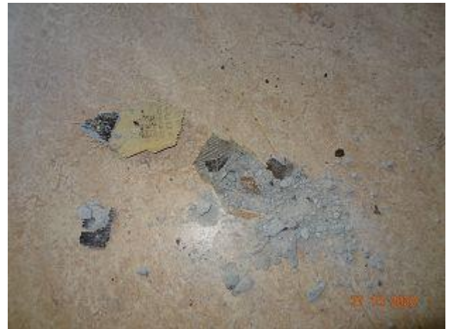
F 046 + 047: Geb. 55 T1 EG, Unter neuem Linobelag Floorflex Kleberückstände Probe P9 von Bodenbelag + Kleber ( Chrysotilasbest in schwarzer Anhaftung )
