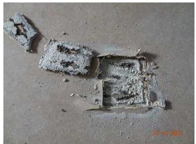
F 073 + 074: Geb. 55 T2, Bodenbelag + Kleber aus Flur, Probe P21 ( asbestfrei )
